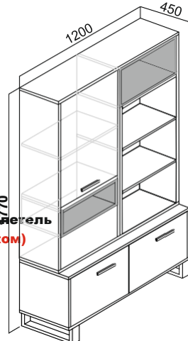
Стеллаж книжный Т4 Двери оснащены системой петель Blum Clip Top Blumotion (с доводчиком)
